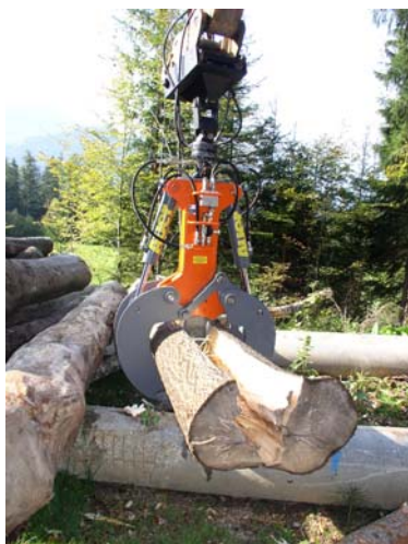
Abb. Typ SPZ110K mit Spaltkeil peilt automatisch immer die Mitte des Stammes an
