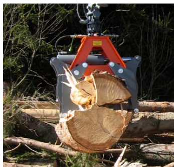
Abb. Typ SPZ125B ohne Spaltkeil System „Beißzange“ mit Abstreifer
